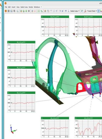
快速分析测量结果，将测量结果自动化、标准化地进行归档。具有装配分析能力。
