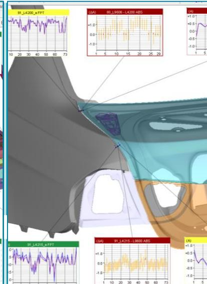
基于测量数据的3D装配尺寸分析功能，分析各类功能尺寸，进行测量数据二次评价。
