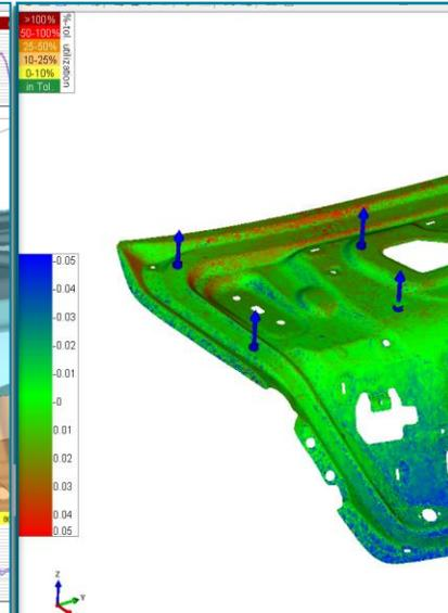
支持导入传统测量数据和非接触式点云数据、CAD数据，分析全局尺寸质量变化。
